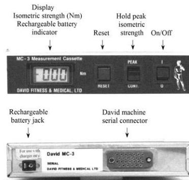
**Figure 3.** MC-3 digital test module
